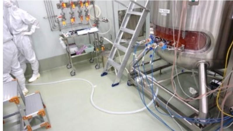
本培養終了後、フィルターろ過による細胞除去を行い、抗体を含むろ過液を回収する。
