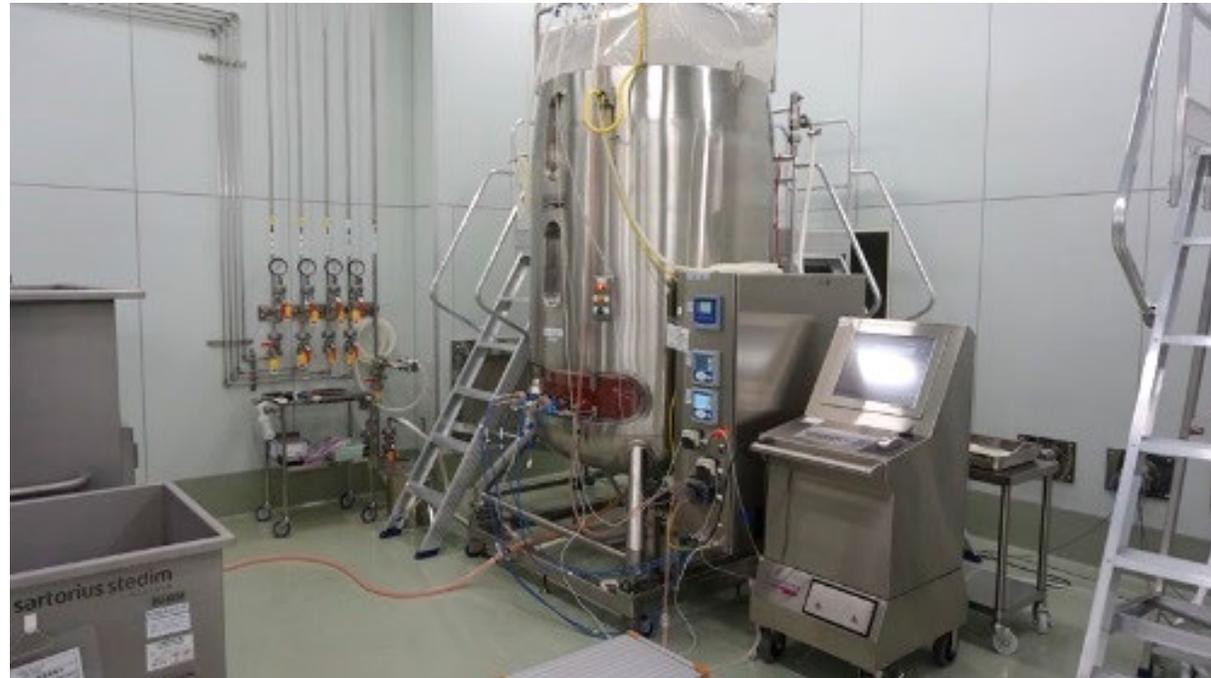
500 L⇒ 2000 L 培養槽 (高さ約3.5 m)へ細胞播種
