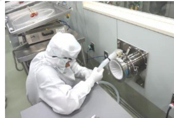
培地調製後、培養室へ移送チューブを設置
